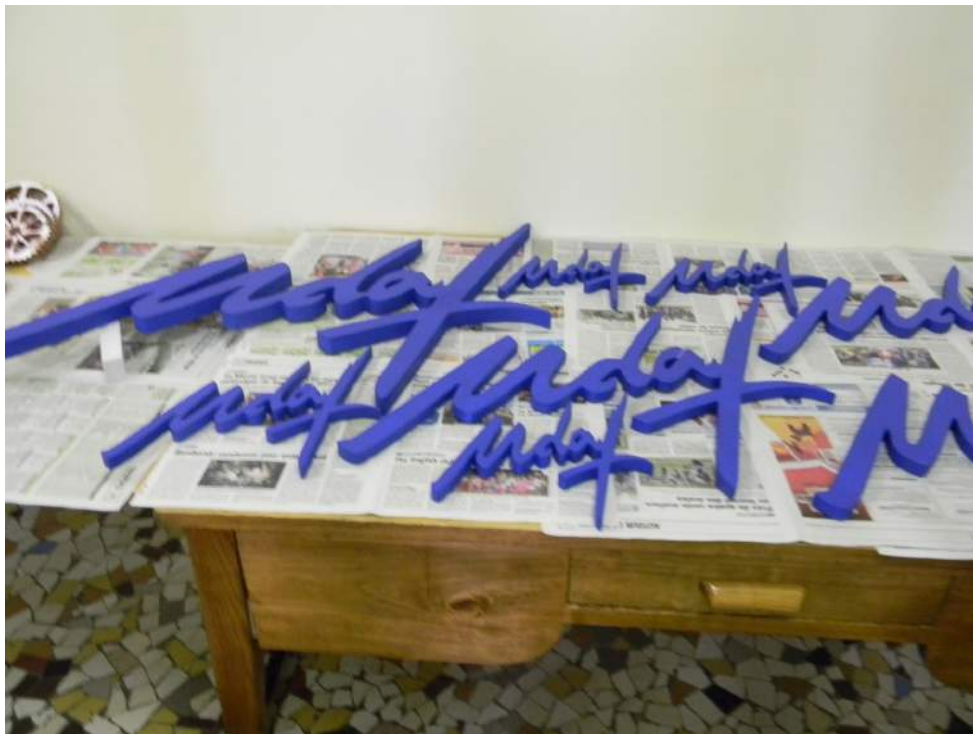
Un exemple de la finesse de découpe permise par le fil chaud piloté par ordinateur: le logo Udaf.
